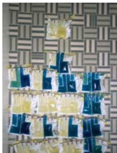
Mikrobiologiske prøveresultater for E. coli, fra første dag av Kabusgo og Kasingo. Most probable number/100mL beregnes etter et statistisk skjema og fargeutslag. Gul er negativ, mens blå positiv for E. coli.
