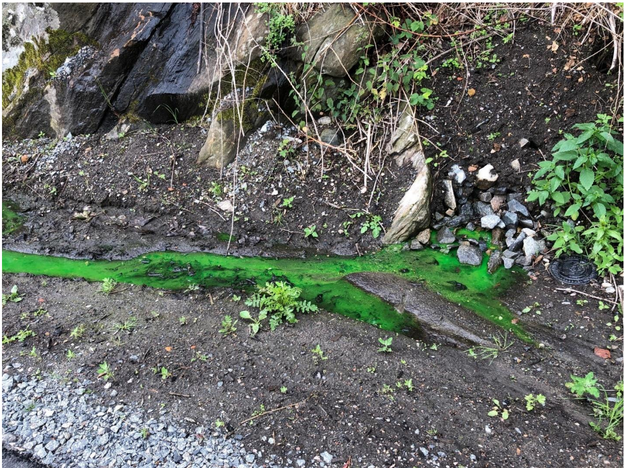
Figur 8 - Eksempel fra en fargetest for å avdekke feilkoblinger (foto: Elisabeth Bokheim)
