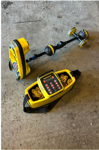
Figur 28. Utstyr til å peile rørtrasé (Foto: Tommy Bakken)
