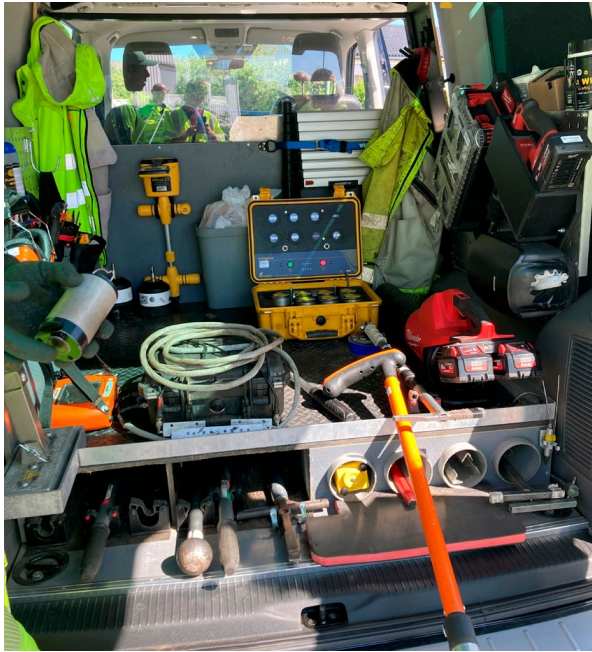
Figur 73. Bil med lekkasjesøkingutstyr for hovedledninger og stikkledninger (Foto: Marie Sagen)
