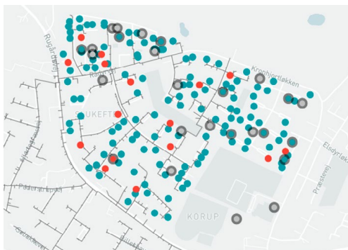
Figur 49. Vannmålere på kart. Rød farge indikerer lekkasjestøy (Kamstrup, 2026)
