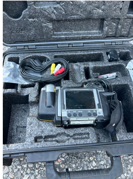
Figur 30. Termokamera (Foto: Tommy Bakken)
