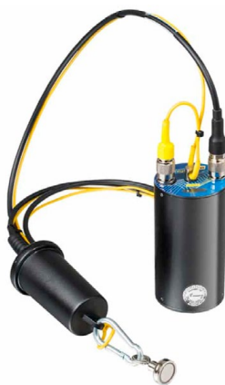
Figur 114. Eksempel på fastmontert overvåkingsutstyr (korrelerende lydlogger med antenne) (Foto: VAV)
