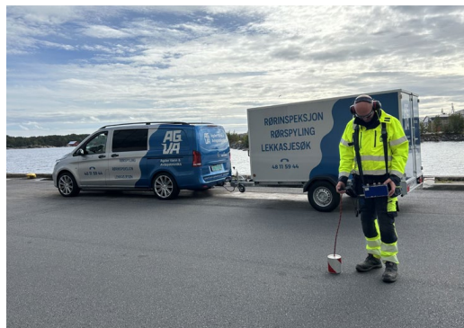
Figur 32. Elektronisk marklytting (Foto: Tommy Bakken)
