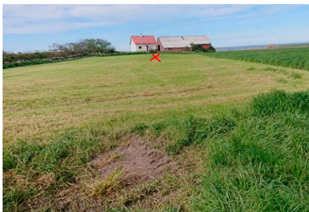
Figur 44. Eksempel på lekkasje på 128 m lang 40 mm PE-stikkledning. Lekkasjen skyldtes en 12 mm sprekk som ga en vannmengde på 0,7 l/s. (Foto: Jon Fosse, Hå kommune)
