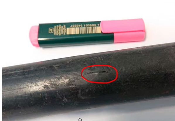
Figur 44. Eksempel på lekkasje på 128 m lang 40 mm PE-stikkledning. Lekkasjen skyldtes en 12 mm sprekk som ga en vannmengde på 0,7 l/s. (Foto: Jon Fosse, Hå kommune)
