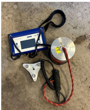
Figur 31. Elektronisk marklytting (Foto: Tommy Bakken)
