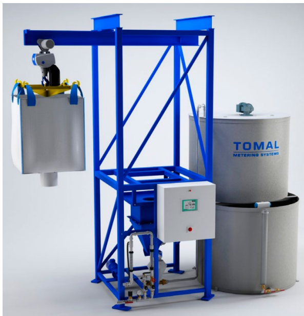
Figur 92: Eksempel på anlegg for håndtering av polymer i pulverform fra storekk. Kran øverst, doserings- og innblandingsutstyr delvis skjult bak styreskap, modningskar øverst til høyre og lagertank under dette. Bilde: Tomal.se
