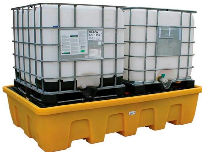
Figur 4: To IBC (palletanker) plassert på et sikkerhetskar. Merk imidlertid: her ser det ut til at det skal svært lite til før kjemikaliet havner på gulvet, for eksempel ved utilsiktet åpning av tømmeventil. Foto: Jonesco (Preston) Ltd. Brukt med tillatelse.
