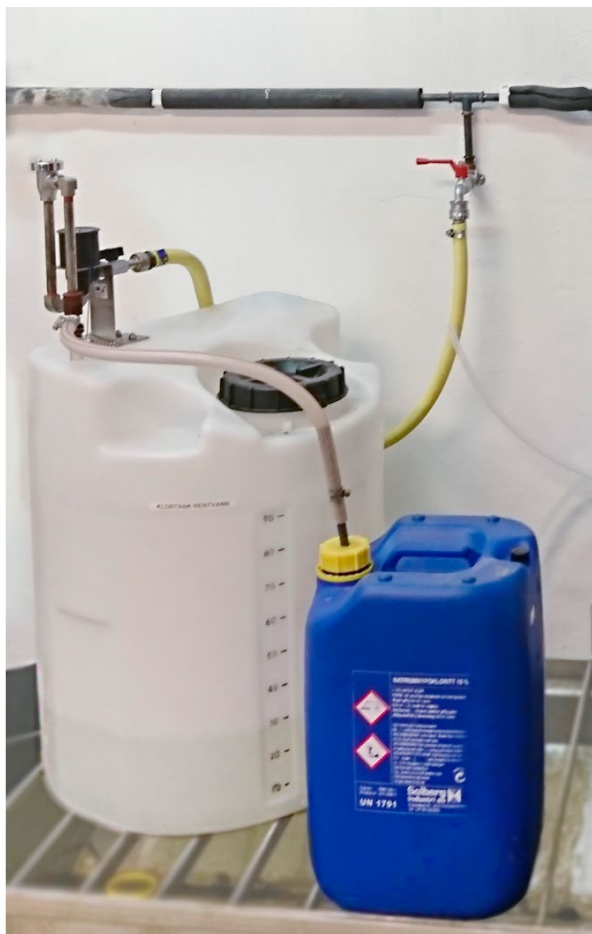
Figur 36: Utstyr for overføring og fortynning ved hjelp av ejetor. Foto: Alfson og Gunderson AS
