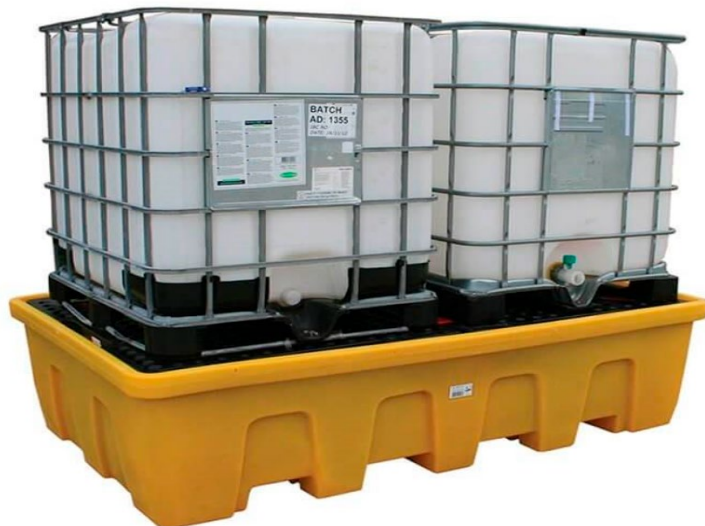
Figur 67: To IBC (pallettanks) plassert på et sikkerhetskar. Merk imidlertid: her ser det ut til at det skal svært lite til før kjemikaliet havner på gulvet, for eksempel ved utilsiktet åpning av tømmeventil. Foto: Jonesco (Preston) Ltd. Brukt med tillatelse.
