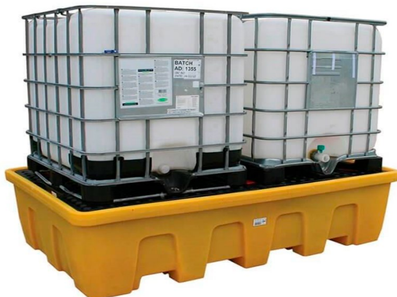
Figur 28: To IBC (palletanker) plassert på et sikkerhetskar. Merk imidlertid: her ser det ut til at det skal svært lite til før kjemikaliet havner på gulvet, for eksempel ved utilsiktet åpning av tømmeventil. Foto: Jonesco (Preston) Ltd. Brukt med tillatelse.
