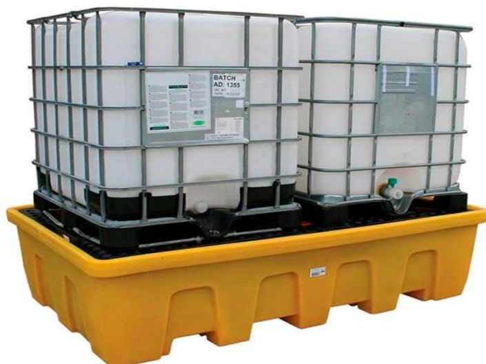
Figur 55: To IBC (pallettanks) plassert på et sikkerhetskar. Merk imidlertid: her ser det ut til at det skal svært lite til før kjemikaliet havner på gulvet, for eksempel ved utilsiktet åpning av tømmeventil. Foto: Jonesco (Preston) Ltd. Brukt med tillatelse.
