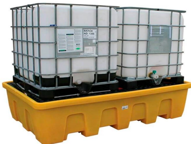
Figur 16: To IBC (pallettanks) plassert på et sikkerhetskar. Merk imidlertid: Her ser det ut til at det skal svært lite til før kjemikaliet havner på gulvet, for eksempel ved utilsiktet åpning av tømmeventil. Foto: Jonesco (Preston) Ltd. Brukt med tillatelse.
