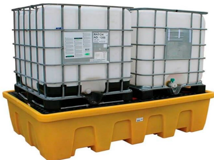
Figur 43: To IBC (palletanker) plassert på et sikkerhetskar. Merk imidlertid: her ser det ut til at det skal svært lite til før kjemikaliet havner på gulvet, for eksempel ved utilsiktet åpning av tømmeventil. Foto: Jonesco (Preston) Ltd. Brukt med tillatelse.
