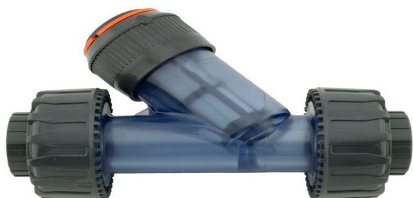
Figur 39: Filter i plastmateriale (PVC) som kan benyttes før doseringspumper. Monteres med avstengningsventiler og omløp. Foto: GPA
