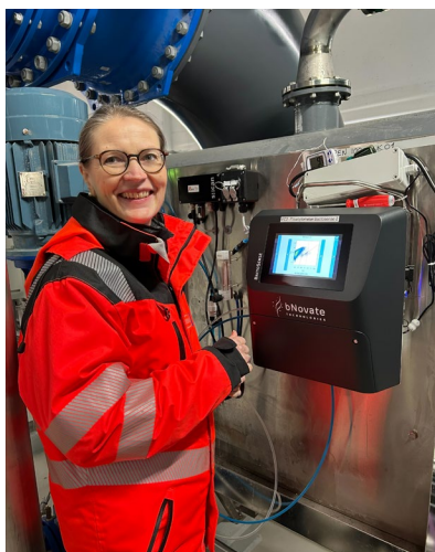
Unni Lea fra IVAR har tatt i bruk flowcytometer for å lære mer om effekten av ulike ozonkonsentrasjoner på antall intakte celler, og få mer kunnskap om hygieniske barrierer ved vannbehandlingsanlegget på Langevatn.
