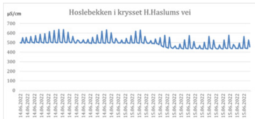
Figur 9: Data fra Hoslebekken i krysset H. Haslums vei 14.-15. juni, viser en jevn utslippspuls og at ledningsevnen er høy.
