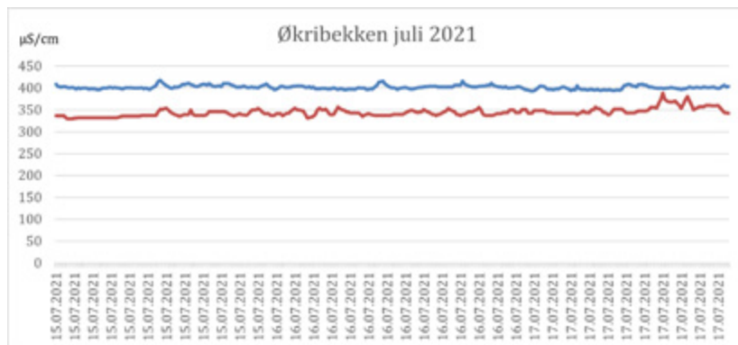
Figur 6: Ledningsevnen er høy, både i oppstrømspunktet og nedstrøms, men det er små variasjoner. Endringen på 10 mS/m mellom oppstrømspunktet og nedstrømspunktet kan skyldes økt kalsiuminnhold i grunnen. Det er høyt innhold av kalsium i dette området. Oransje: Oppstrøms, blått: nedstrøms
