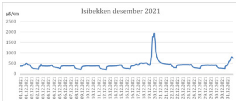
Figur 4: Logg fra sensor 1 i Isibekken desember 2021 viser generelt høy ledningsevne og regelmessige forurensningspulser med varighet i ca. 3 døgn.
