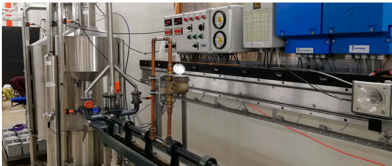
I Justervesenets flow-laboratorium testes vannmålere mot kalibrerte volumetriske standarder, ved Q_n (flowrate) opp til 10 \text{ m}^3/\text{time} , i en egen kaldt-vannrigg. Denne riggen brukes blant annet til å teste vanlige husholdningsvannmålere.
