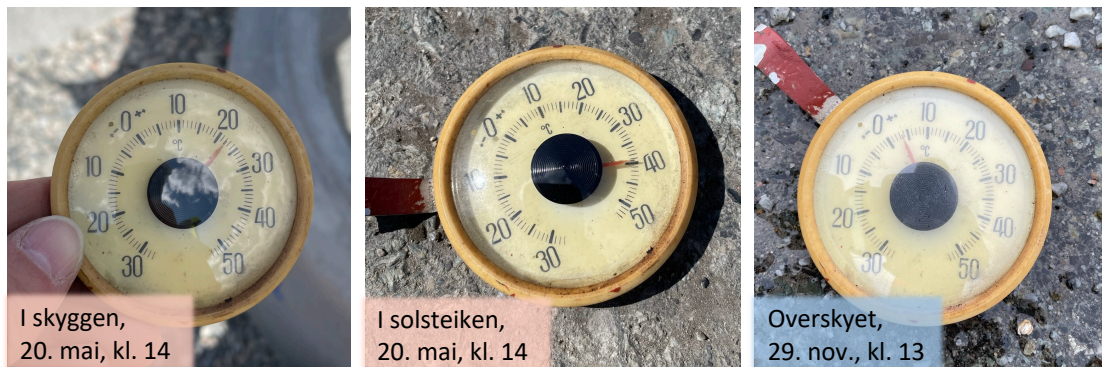
Figur 16: Eksempler på målte temperaturer på plassen. De to første bildene er tatt med ca. 4 min. mellomrom, rundt kl. 14.00 den 20. mai. På det første bildet hadde termometeret ligget i skyggen, på det andre, hadde det ligget noen minutter i solsteiken. Det siste bildet er fra 29. november, ca. kl. 13.00 (Foto: Drammen kommune).
