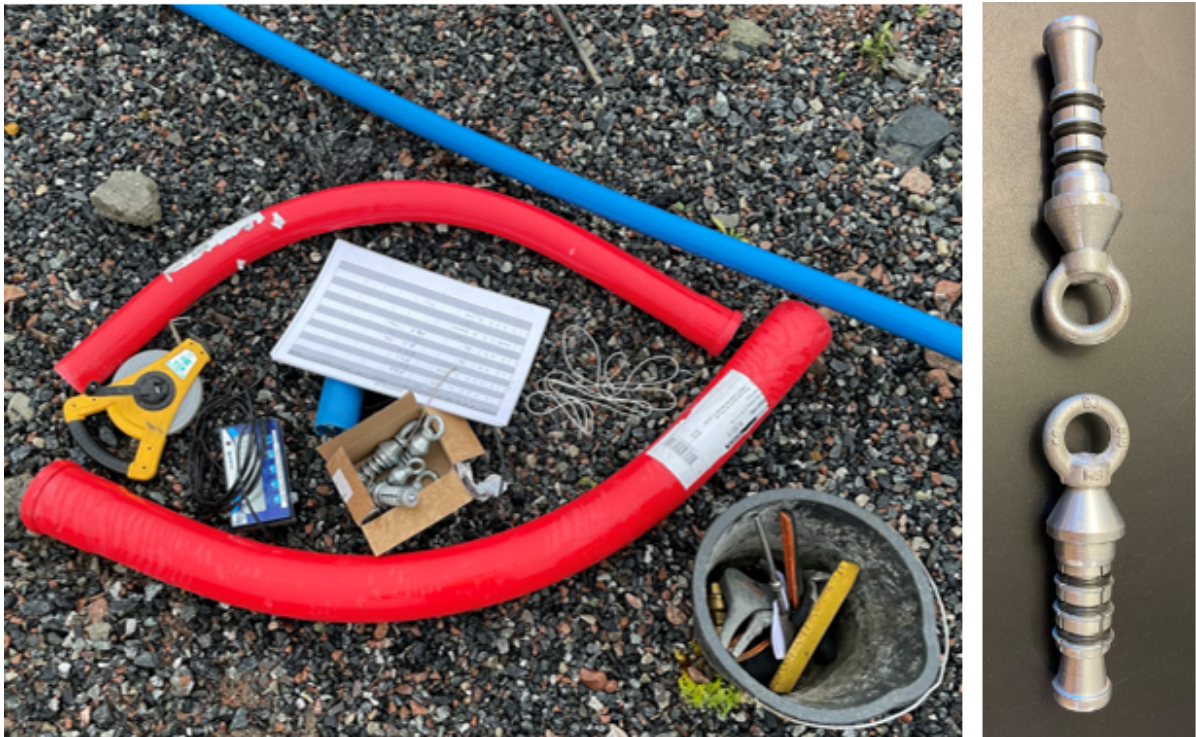
Figur 7: Utstyr som ble benyttet for å gjennomføre forsøkene. Bildet til høyre viser trekkeheder som ble benyttet til Ø32 PE-rør (Foto: Drammen kommune). Bildet til venstre viser noe av utstyret som ble benyttet på plassen (foto: Drammen kommune).
