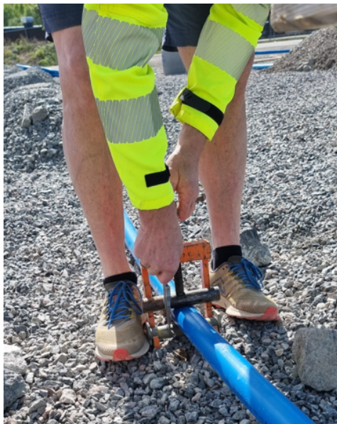
Figur 14: Bildet til venstre viser hvordan deformasjonen ble utført i felt (Foto: Multiconsult). Bildet til høyre illustrerer prosentvis deformasjon av rør fra 10 – 30 % av rørtverrsnittet for Ø32/50 (Illustrasjon: Multiconsult).
