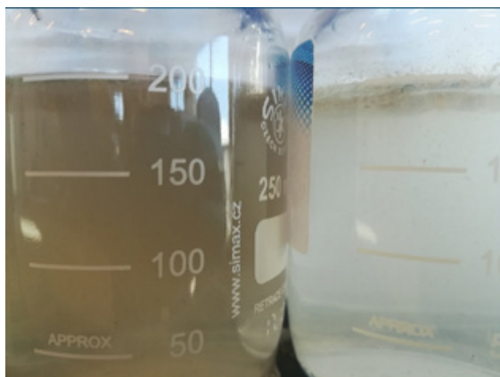
Bilde 7: Test av polymerdosering på Bergsodden RA med behandlet utslippsvann til venstre. Flaske til høyre viser utslippsvann etter polymerdosering og slamuttak
