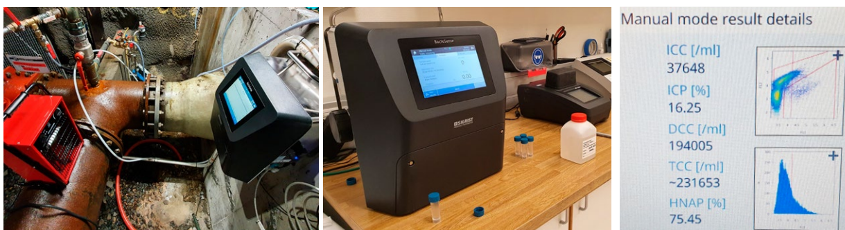
Figur 11: Bactosense flowcytometer installert på utløpsledningen til et bergsprengt drikkevannsmagasin (t.v.), som laboratorieinstrument (m) og resultater/plott (t.h.).
