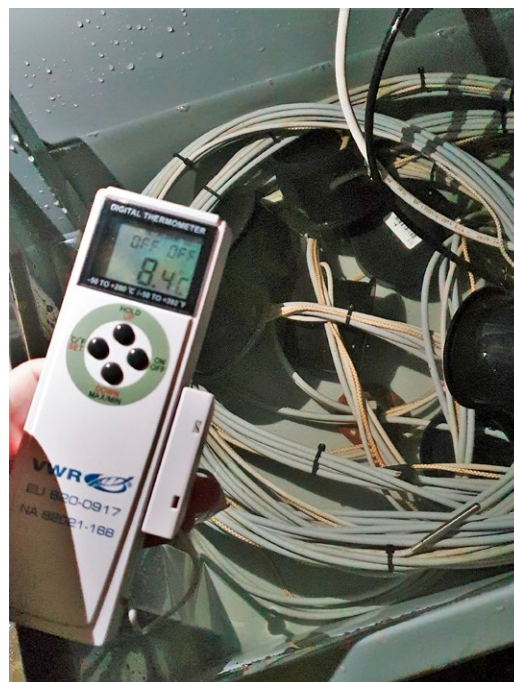
Figur 22: Kalibrering av temperaturloggere. Alle legges i en balje med kjent vanntemperatur. Sensorene justeres etter denne.
