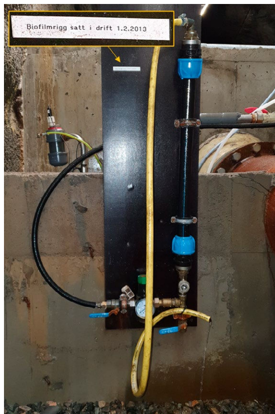
Figur 27: Biofilmmonitor. Biofilm gror på innsiden av røret som kappes av et gitt antall cm. Merket med navn og tid for installasjon.
