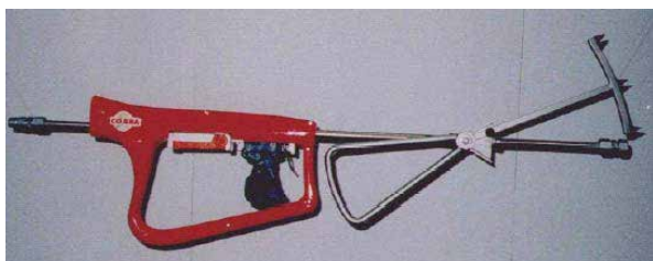
Figur 25: Skjærslokkeren er en integrert Hydroabrasiv skjæreenhet som etter å ha skåret hull i veggen tilfører vanntåke inne i bygningen.
