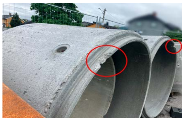
Figur 5-3: Skade på spissende på kumringer som er oppbevart på byggeplass. Dette kan være forårsaket av feil håndtering av delene ved transport eller oppbevaring.
