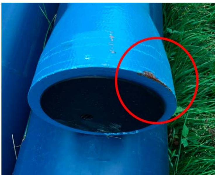
Figur 5-5: Beskyttelsesbelegget på støpejernsrøret er skrappt vekk og det er synlig rust på den eksponerte overflaten (rød ring). I tillegg ligger muffa og klemmer på plast-røret under.
