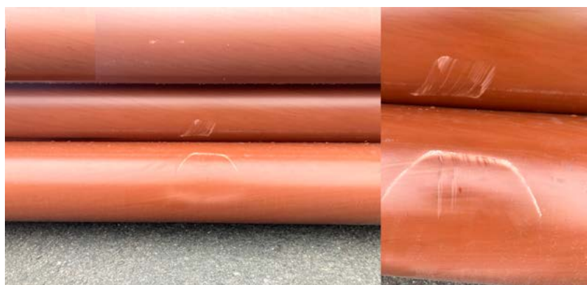
Figur 4-1: Punktbelastning med synlige riper, hvite merker og bulker på røroverflaten. Skadene skyldes trolig feil håndtering under lagring eller transport.
