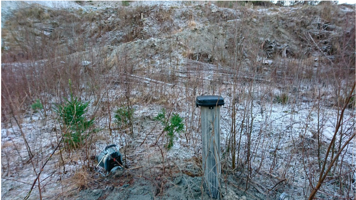
Figur 12: Avslutning av prøvetakingsbrønn med låsbart lokk. Foto: Asplan Viak v/Rolf E. Forbord.
