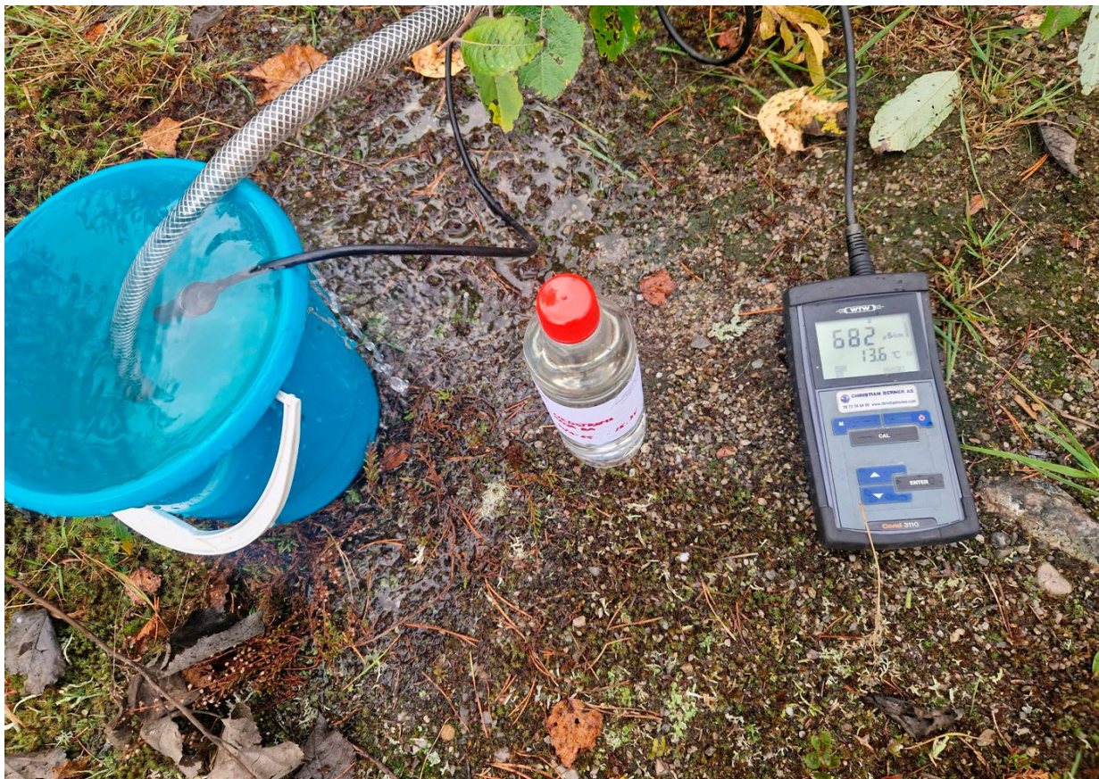
Figur 16: Renpumping av prøvetakingsbrønn B3 ved Rena infiltrasjonsanlegg for 6000 pe. Uttak av prøve når grunnvannet er klart, og konduktivitet og temperatur har stabilisert seg. Foto: Asplan Viak v/Knut R Robertsen.
