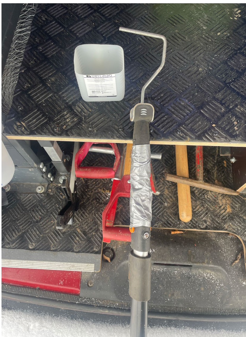
Figur 11: Bilde 1: Prøvetakningsstang, gjerne så lang som mulig for å bruke i dype kummer. Denne kan bli opptil 4 meter lang, man lager hull i hver side av prøvekoppen og trer den på skaftet. Prøvekoppen skylles 3 ganger før ny prøve tas og byttes ut ved jevne mellomrom. Det finnes også flere ferdige varianter som kan kjøpes. Bilde 2: Vannprøvetaker hvor prøveflaske festes i stangen.
