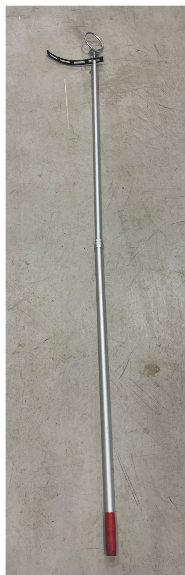
Figur 11: Bilde 1: Prøvetakningsstang, gjerne så lang som mulig for å bruke i dype kummer. Denne kan bli opptil 4 meter lang, man lager hull i hver side av prøvekoppen og trer den på skaftet. Prøvekoppen skylles 3 ganger før ny prøve tas og byttes ut ved jevne mellomrom. Det finnes også flere ferdige varianter som kan kjøpes. Bilde 2: Vannprøvetaker hvor prøveflaske festes i stangen.
