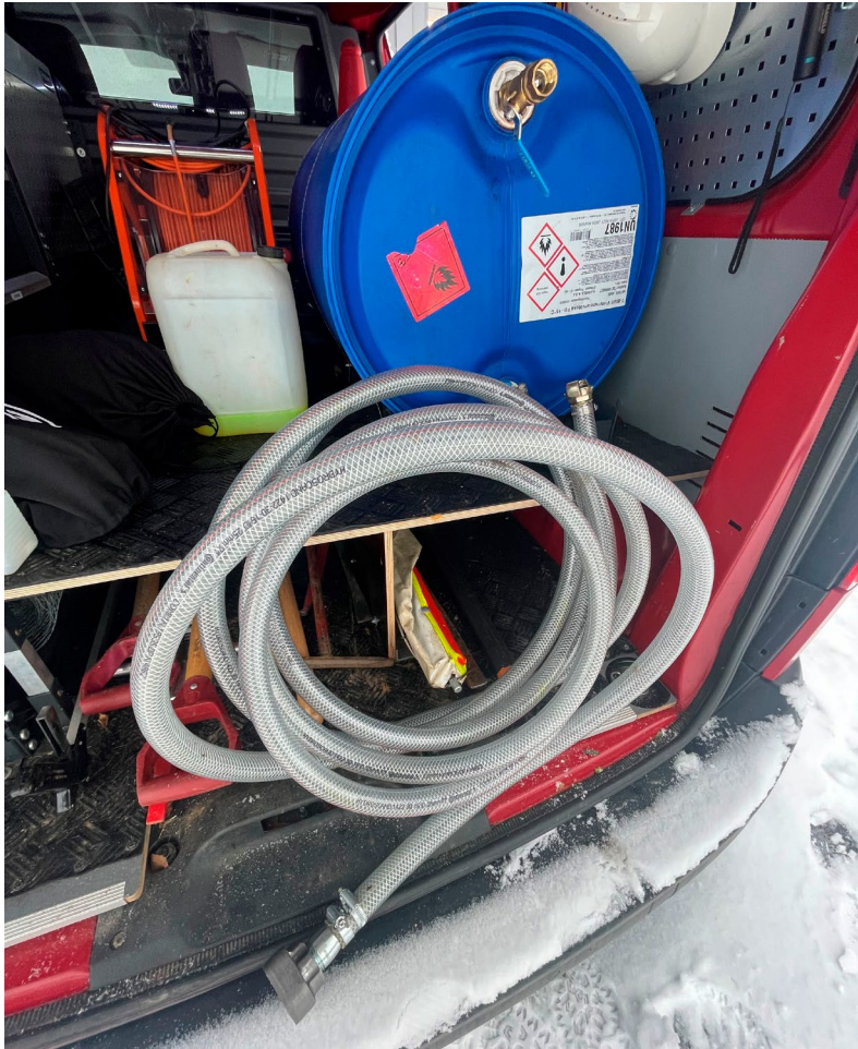
Figur 18: 200 l tønne for farging med store mengder vann. Viktig at tønne sikres godt i bilen og at det enkelt kan tilsettes farge og vann.
