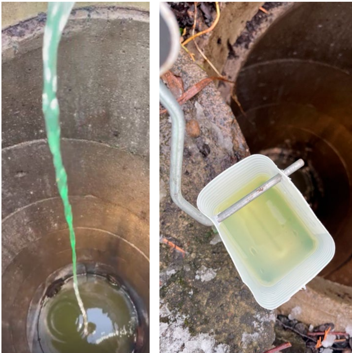
Figur 17: Eksempel på at det kan være vanskelig å observere farge i dyp kum. Da er det lurt å bruke en prøvekop for å ta opp vann med jevne mellomrom. Det kan også være lettere å observere farge når man heller ut vann eller gjennom mobilkamera, spesielt hvis fargen er fortennet veldig.
