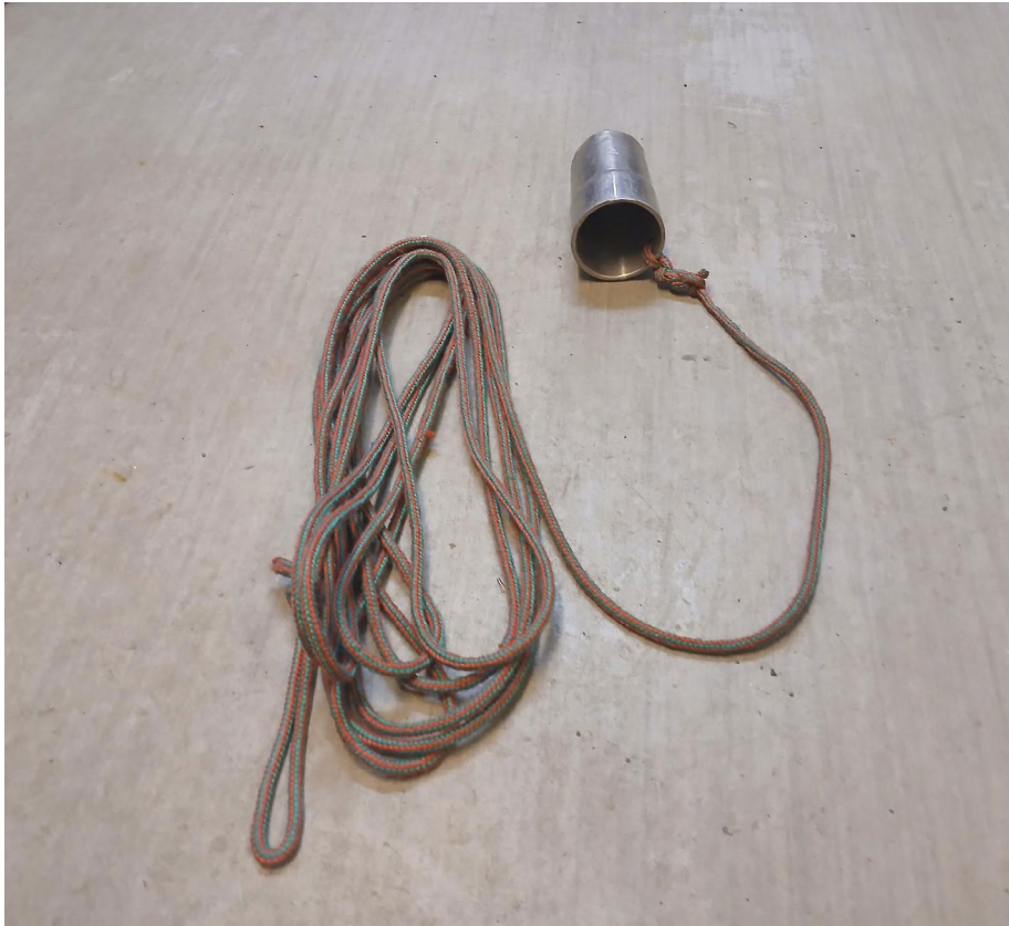
Figur 12: Vannprøvekopp laget av metall og festet i tau.
