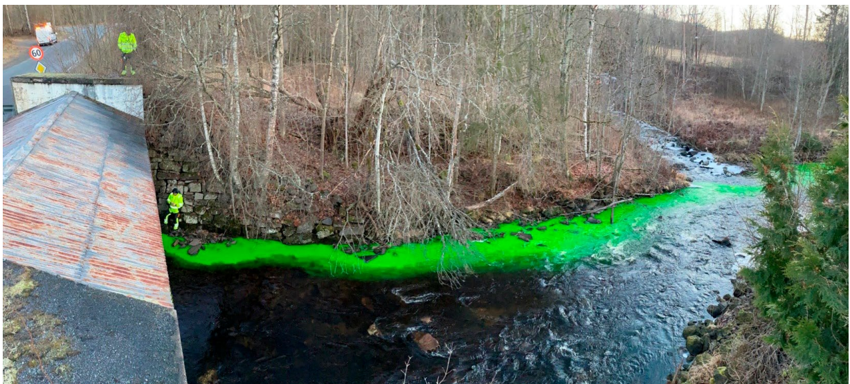
Figur 19: Kildesporing med bruk av fargestoff.
