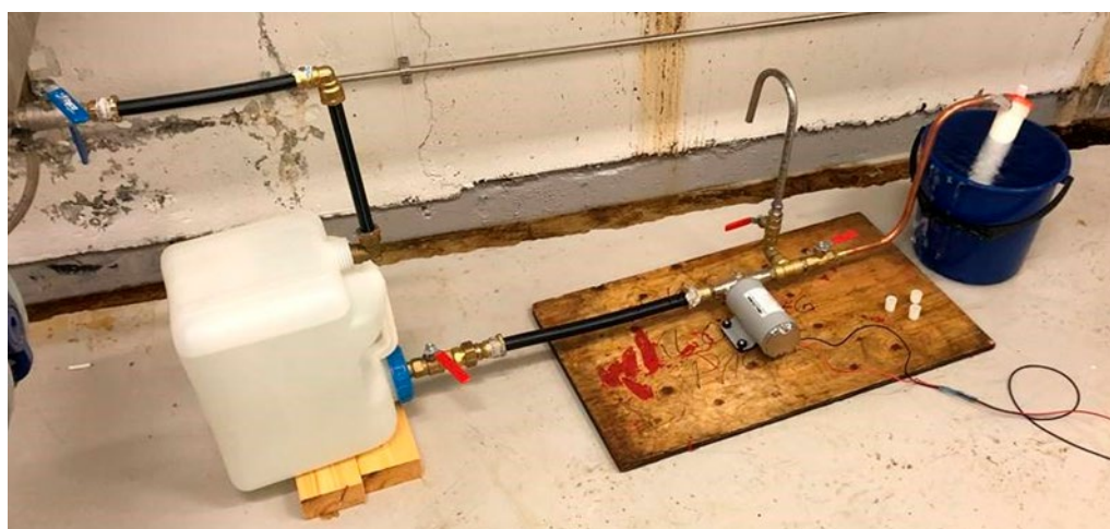
Figur 5.12. Ultrafiltrering for uttak av storvolumprøver (10-100 L) ved Rore.
