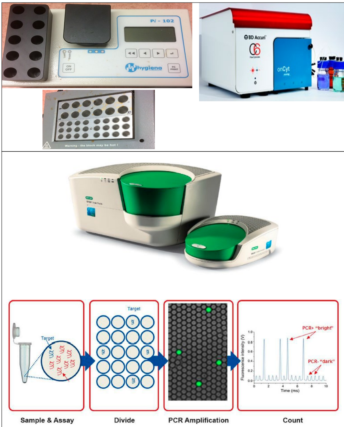
Figur 2.1. Illustrasjon av instrumenter og analyser: i) ATP-analysator, med varmeblokk (venstre øverst), ii) Flow-cytometer-FCM (høyre øverst), og iii) ddPCR-analyser (nederst).
