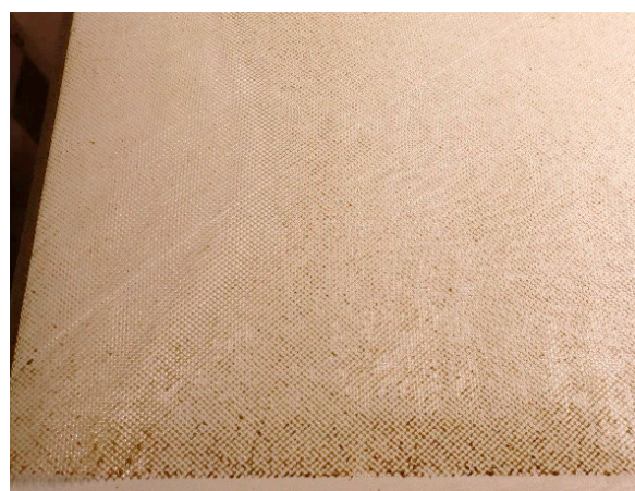
Figur 5-12: Fødespacer som har ligget mellom to membranark fra NF1-elementet. Innløpsenden er nederst i bildet. Foto: SINTEF
