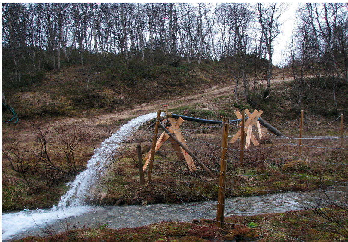
Figur 6-9. Prøvepumping av skråstilt løsmassebrønn i foten av en stor esker ved Glåmos (Foto Bernt Olav Hilmo).
