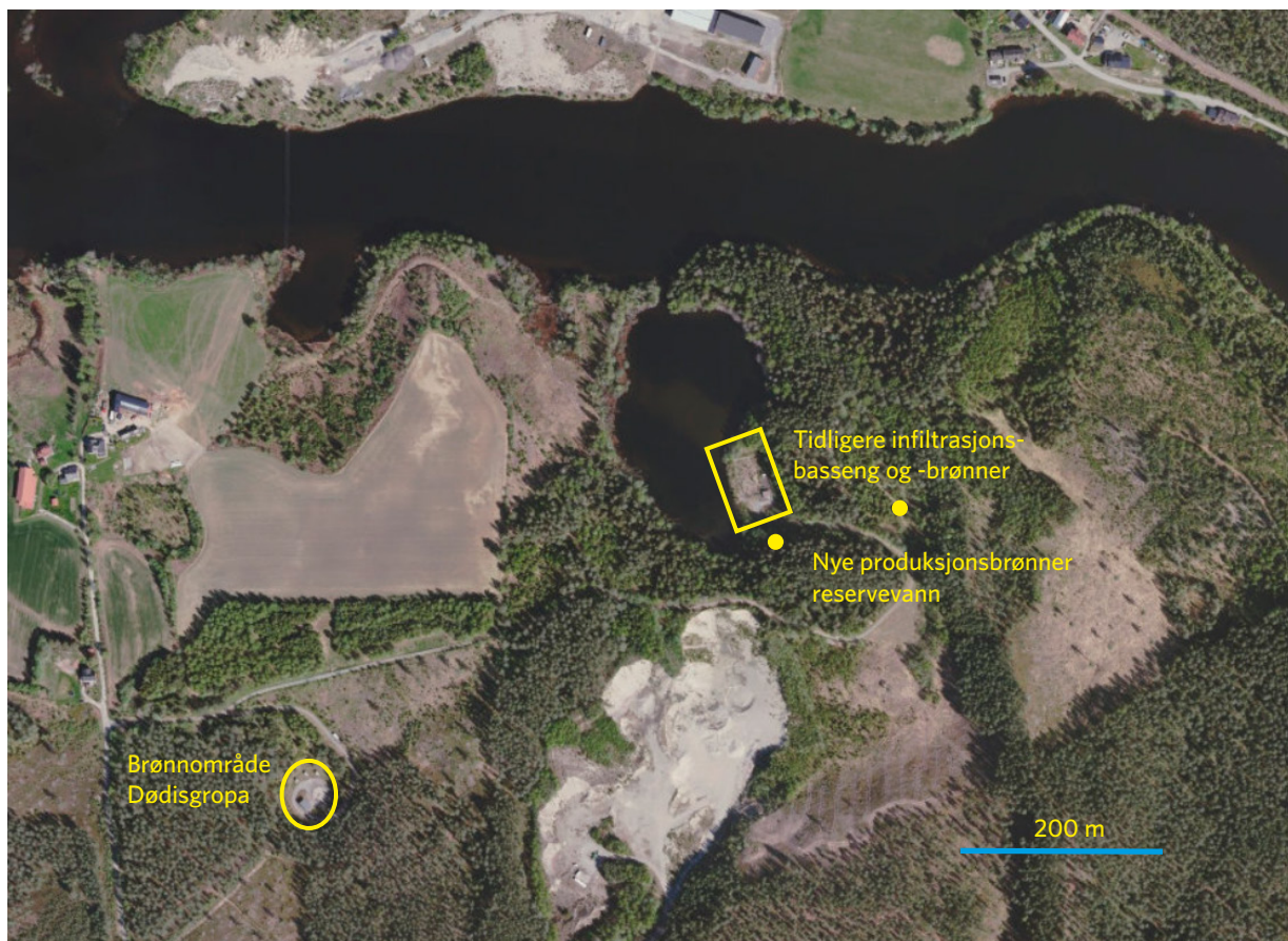
Figur 1. Flybilde som viser plassering av produksjonsbrønner og tidligere infiltrasjonsanlegg ved Kilemoen grunnvannsanlegg.
