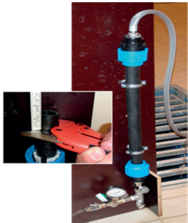
Figur V8. Bilde av biofilmmonitor (BFM) som ble anvendt i Sirdal (opprinnelig designet av Karl Olav Gjerstad, IVAR).
