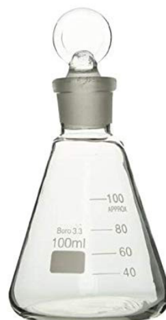
Figur 10.1. Erlenmeyerkolbe med glasskork for screening/kildesporing av lukt i vann.
