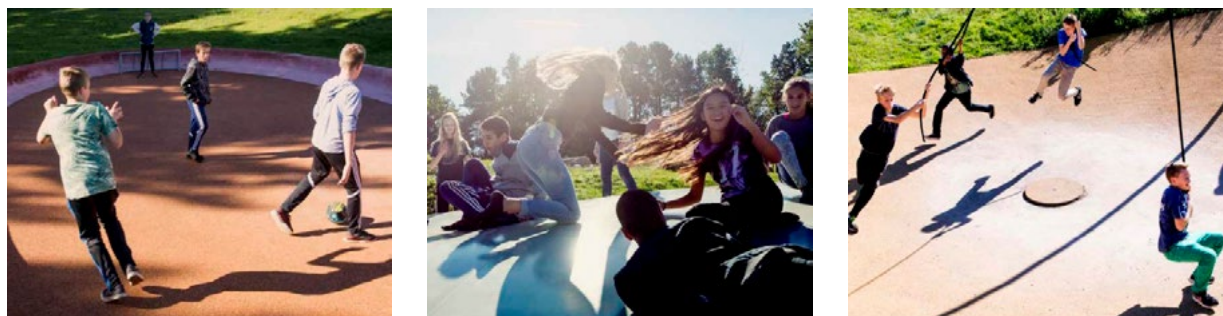
Figur 17: Fotballbane, hoppepute og karusell har en samlet kapasitet på 379 m 3 . Både fotballbanen og karusellen er konkave former med pop-up rist i bunnen. Hoppeputa er spent over en konkav form og faller sammen og utgjør bunnen i et regnvannsbasseng (foto Carsten Ingemann, VAND PÅ SIDELINJEN).
