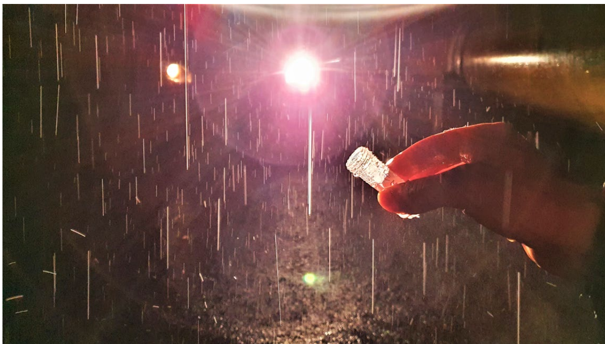
Figur 8: Prøvetaking av drypp i berganlegg (Foto: U. Eriksen).
