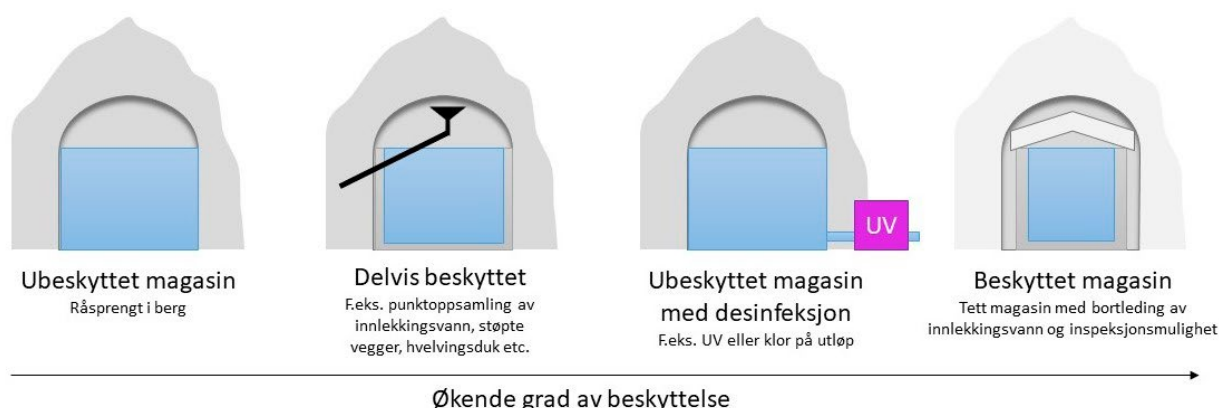
Figur 8: Illustrasjon av ulike varianter drikkevannsmagasin i berg. Den første til venstre er mest anvendt. Den neste har vært forsøkt med varierende hell. Dvs. respondenter som svarte på denne rapportens spørreundersøkelse hadde ikke fått ønsket effekt av beskyttelsestiltakene, det kan være flere grunner til det, og det kan være andre drikkevannsmagasin hvor slike tiltak har gitt ønsket resultat. Bergmagasin med fast desinfeksjon vil være en god løsning. Helt innebygde magasin er sannsynligvis lite relevant pga. høye byggekostnader og kun marginalt bedre hygienisk beskyttelse enn magasin med desinfeksjon.
