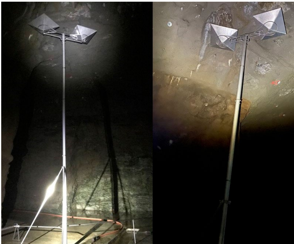
Figur 7: «Hjemmelaget» anordning for prøvetaking av innlekkingsvann (Foto: K. H. Buan).
