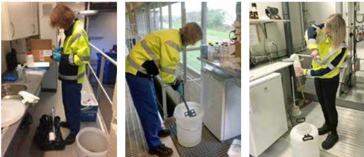
Figur 15 Sekundærprøvetaking: Klargjøre → røre i dunken → øse opp fra dunken og helle over på flaske.
