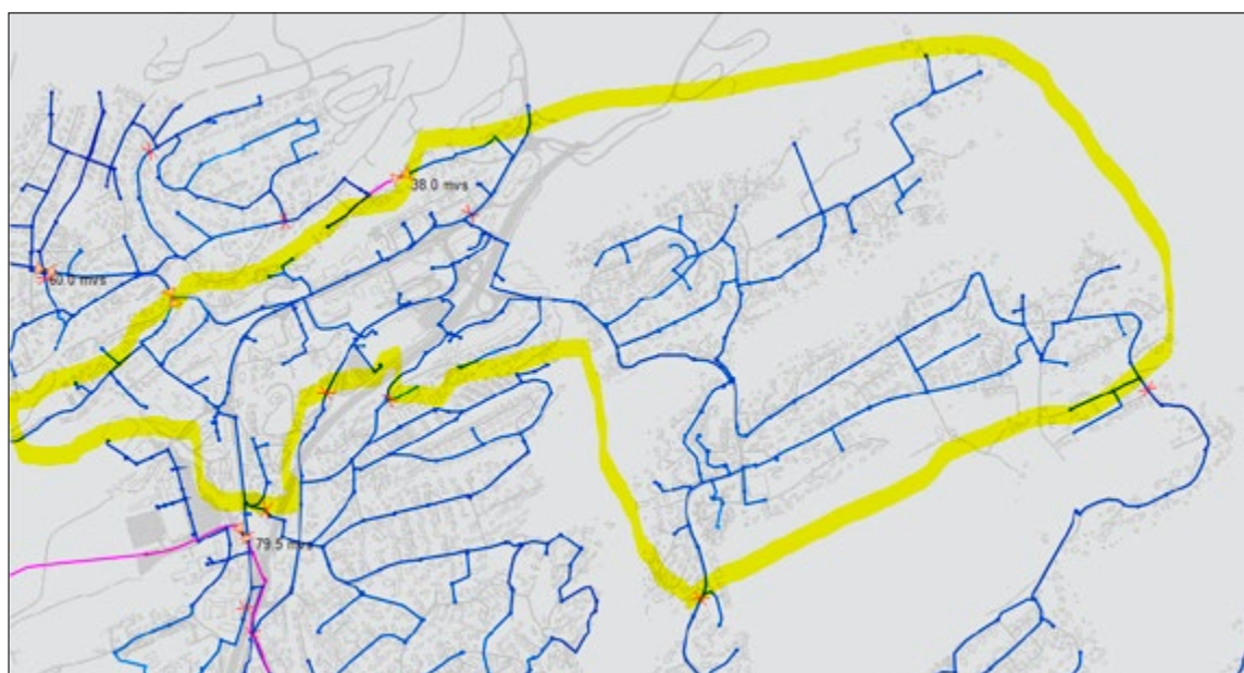
Figur 27: Ny Åstadbakken trykksone der trykket er planlagt senket med 8 mVS. Figuren viser modellert trykksone i Aquis.
