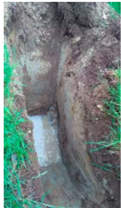
Figur 3.7: Sjakting med gravemaskin – eksempler på lagdeling i løsmasser. Øvre løsmasser har mindre lagringsfasthet enn de underliggende, fastere massene, og er dermed bedre egnet for etablering av infiltrasjonsfilter. Rustbrune løsmasser har generelt god fosforbindingskapasitet.
