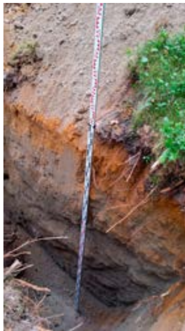
Figur 3.7: Sjakting med gravemaskin – eksempler på lagdeling i løsmasser. Øvre løsmasser har mindre lagringsfasthet enn de underliggende, fastere massene, og er dermed bedre egnet for etablering av infiltrasjonsfilter. Rustbrune løsmasser har generelt god fosforbindingskapasitet.
