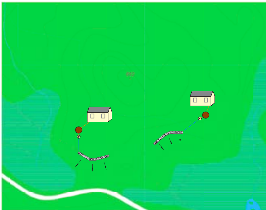
Figur 3.20: Strømningsforhold ved infiltrasjon i hellende terreng med konveks og konkav overflate på grunnvannsmagasinet. I eksempel til venstre (konveks) spres vannet over større areal og er derved bedre enn eksempel til høyre (konkav)
