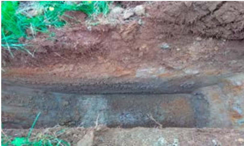
Figur 3.6: Sjakting med gravemaskin – lagdeling over tette masser
