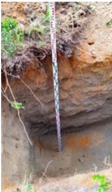
Figur 3.7: Sjakting med gravemaskin – eksempler på lagdeling i løsmasser. Øvre løsmasser har mindre lagringsfasthet enn de underliggende, fastere massene, og er dermed bedre egnet for etablering av infiltrasjonsfilter. Rustbrune løsmasser har generelt god fosforbindingskapasitet.
