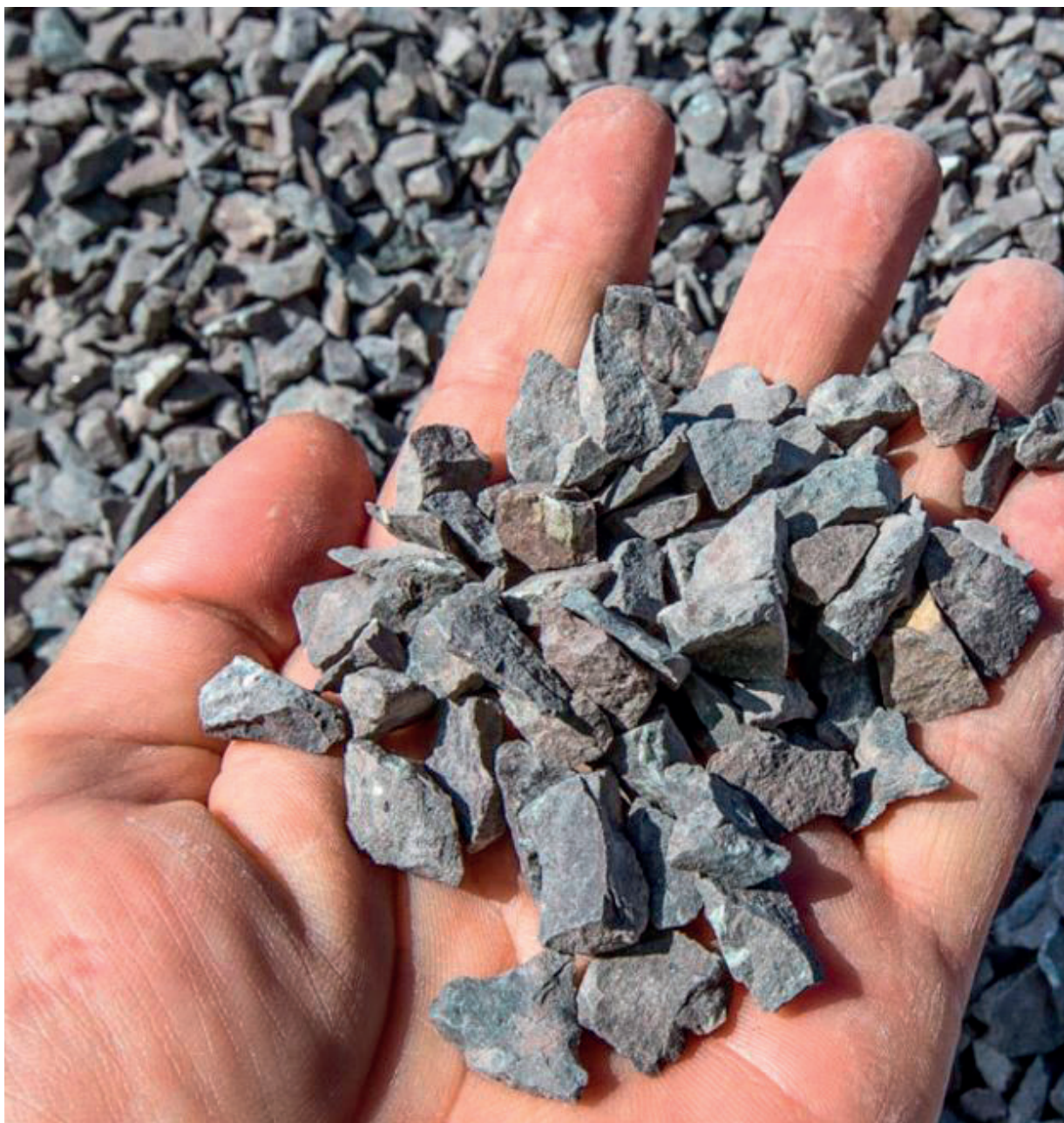
Figur 24: Hvis lokale egnede masser ikke finnes, bør det vurderes å skille mellom masser til fundament og omfylling. Eksempelvis kan en bruke en kort fraksjon (8-11 eller 8-16) til fundamentet og en lang fraksjon (4-22) til omfyllingsmasser. Det er viktig å be om siktekurve for lange fraksjoner for å sikre at de er velgraderte. (Foto: Norsk Bergindustri)
