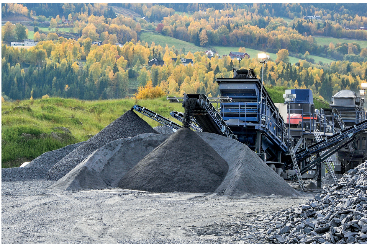
Figur 23: Lokale masser må ofte bearbeides for å være egnet som omfyllingsmasser, enten ved sikting/sortering eller som her ved knusing i mobilt knuseverk (foto: Knut Opeide/Statens vegvesen).
