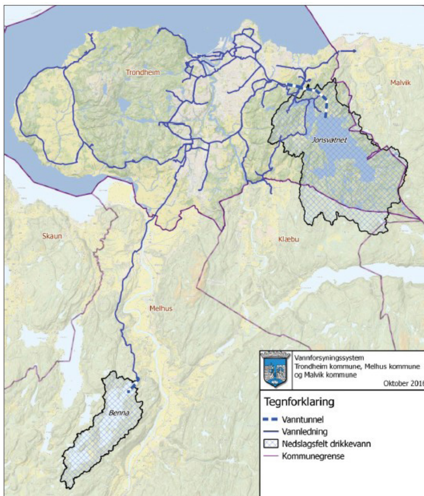
Figur 12: Vannforsyningssystemet tilhørende Trondheim vannverk.
