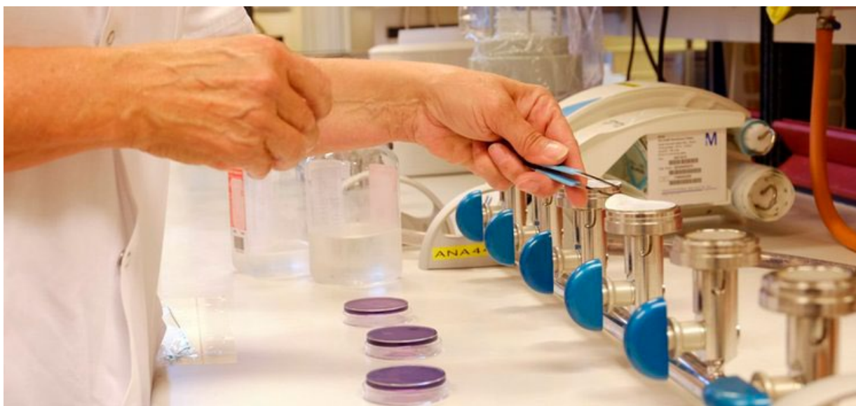
Figur 1. Filtrering av vann for mikrobiologisk analyse. Foto: Carl-Erik Eriksson, Labtjenester.no
