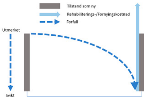
Figur 2: Reparasjon ved funksjonssvikt.
