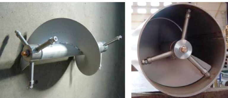
Figur 4-8. Roterende enhet for avskjæring av lysstråler fra UV-aggregater (Eggers et al., 2019).
