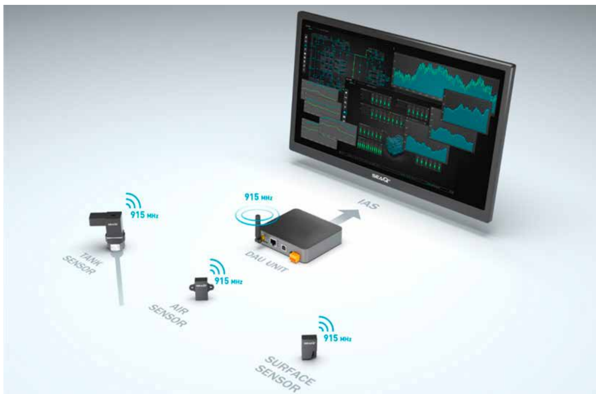
Figur 11. Oversikt over kommunikasjon fra sensorer, via gateway og videre til database/skyløsning (Figur EL-Watch)
