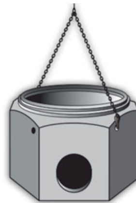
Figur 27: Løfting av bunnseksjon i betong
