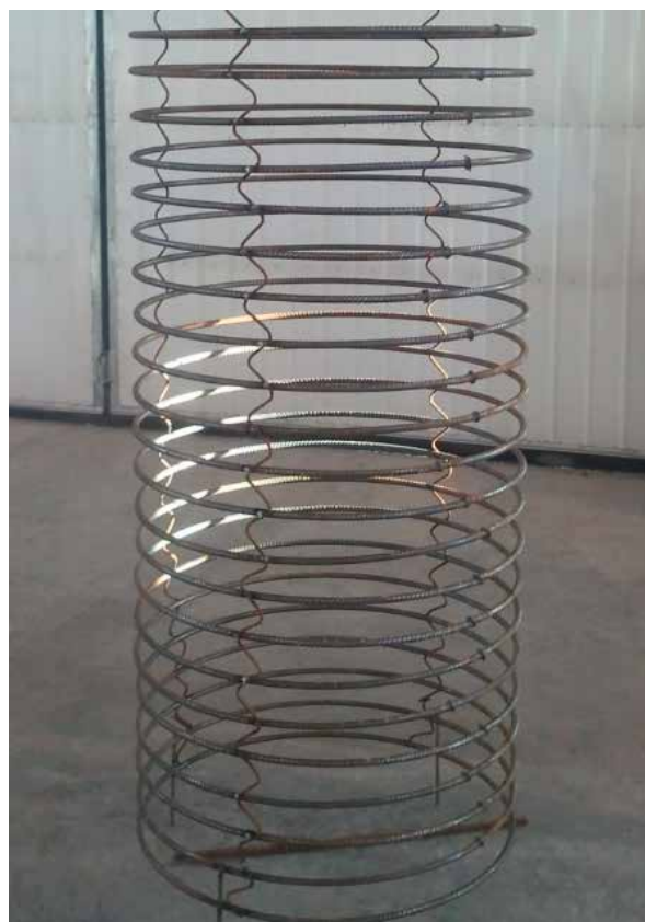
Figur 9: Typisk symmetrisk armering av falsrør
