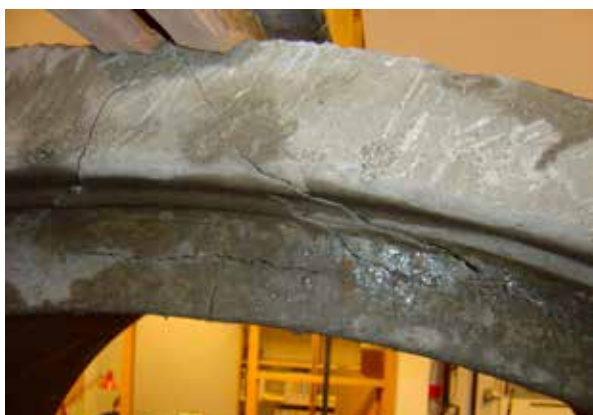
Figur 8: Test av bruddstyrke for betongrør (foto: Østraadt Rør Gruppen AS)
