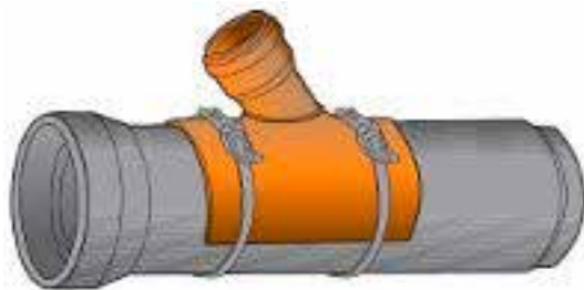
Figur 33: Rørtilknytning med sadelgren, klassisk, med 45° gren
