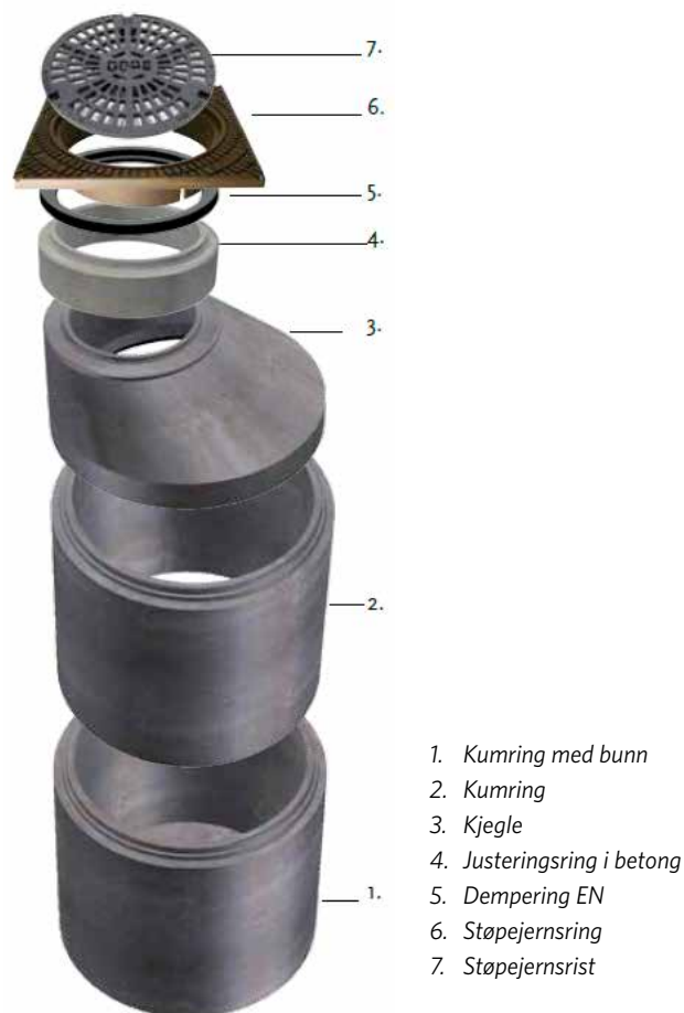
Figur 16: Oppbygging av typisk kum
