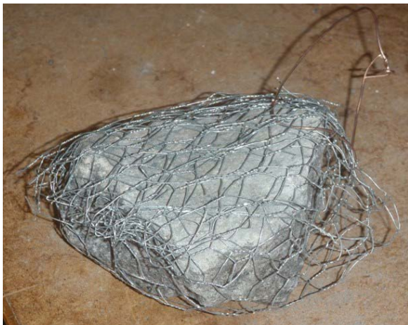
Figur 9.2: Eksempel på «spioner» før og etter utplassering i overvannsledning for å finne spillvann i overvannsledninger.
