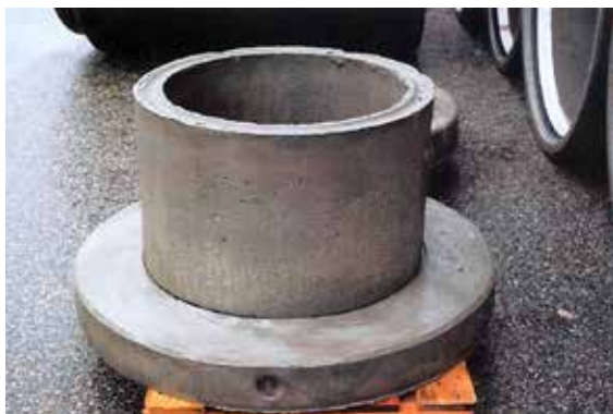
Illustrasjon 22: Eksempel på bunnløs overgangskum for å markere eiergrensesnitt Foto: Stavanger kommune
