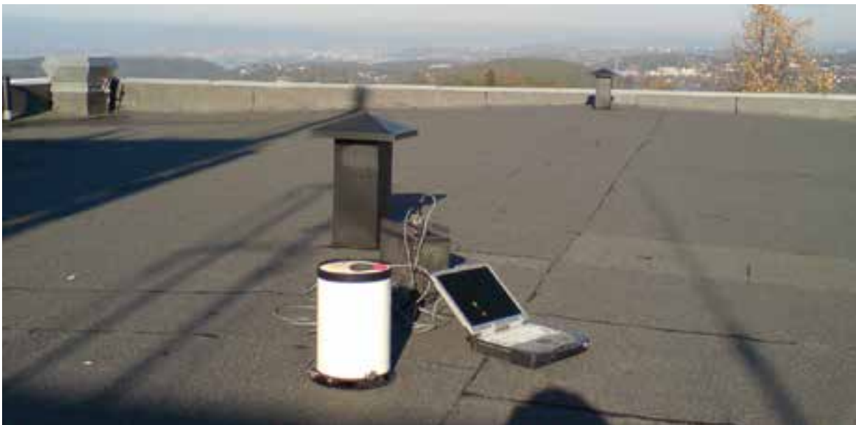
Figur 5.4.1.2: Nedbørmåler på tak (privat bilde).
