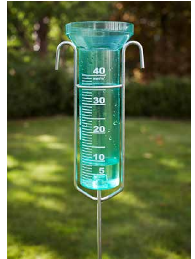
Figur 5.4.2.1: Mekanisk oppsamlingsmåler for nedbør (privat bilde).
