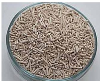
Figur 3-3 Filtermasse (zeolitt) for adsorpsjon av nitrogen i PSA og VSA-systemer for oksygenproduksjon
