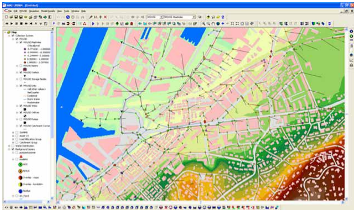
Figur 17. Sammenkobling av modell for 1-dimensjonal rørstrømning i ledningsnett (Mike Urban/Mouse) med MIKE 21 og MIKE Urban overflatemodeller
