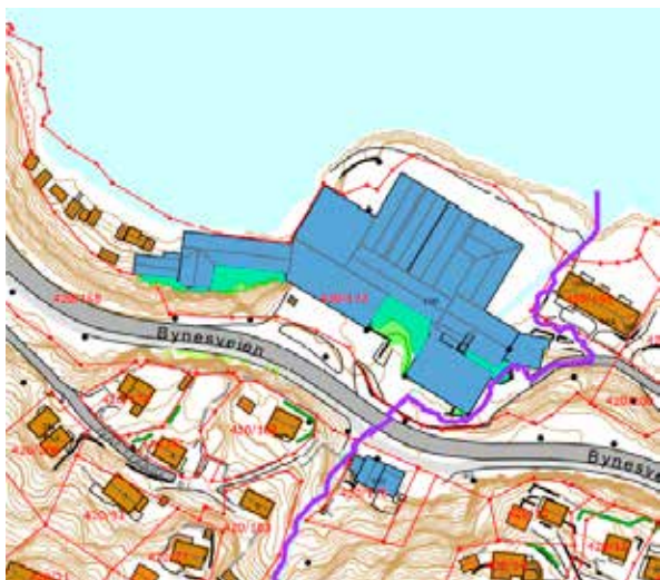
Figur 23. Eksempel på flomveg ved Trolla i Trondheim. Flomveg for scenarioet «tett kulvert» er vist rundt bygning. Til høyre bilde fra flom i Trolla 22.09.04 hvor bekken rant gjennom bygningen.
