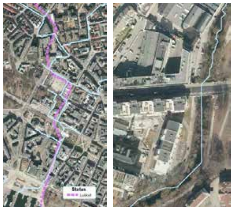
Figur 20. Historisk elv/bekk i forhold til beregnet flomveg (venstre bilde). Beregnet flomveg i forhold til dagens åpne elv (høyre bilde). Eksempler fra Oslo kommune.
