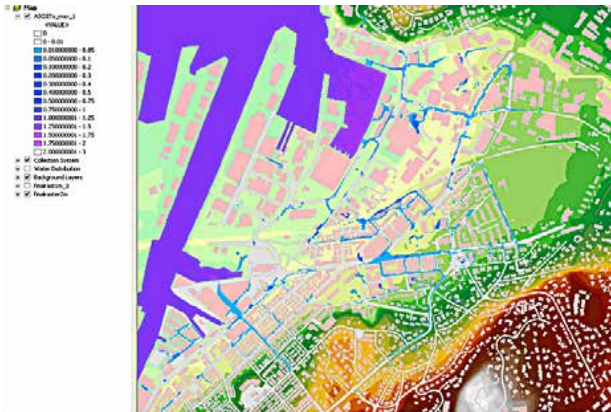
Figur 18. Oversvømte arealer for en nedbørhendelse med 50 års gjentakintervall ved Møllenberg Trondheim simulert med en kombinert modell for overflatestrømning og rørmodell (Mike Urban og Mike Flood) (DHI, 2007)
