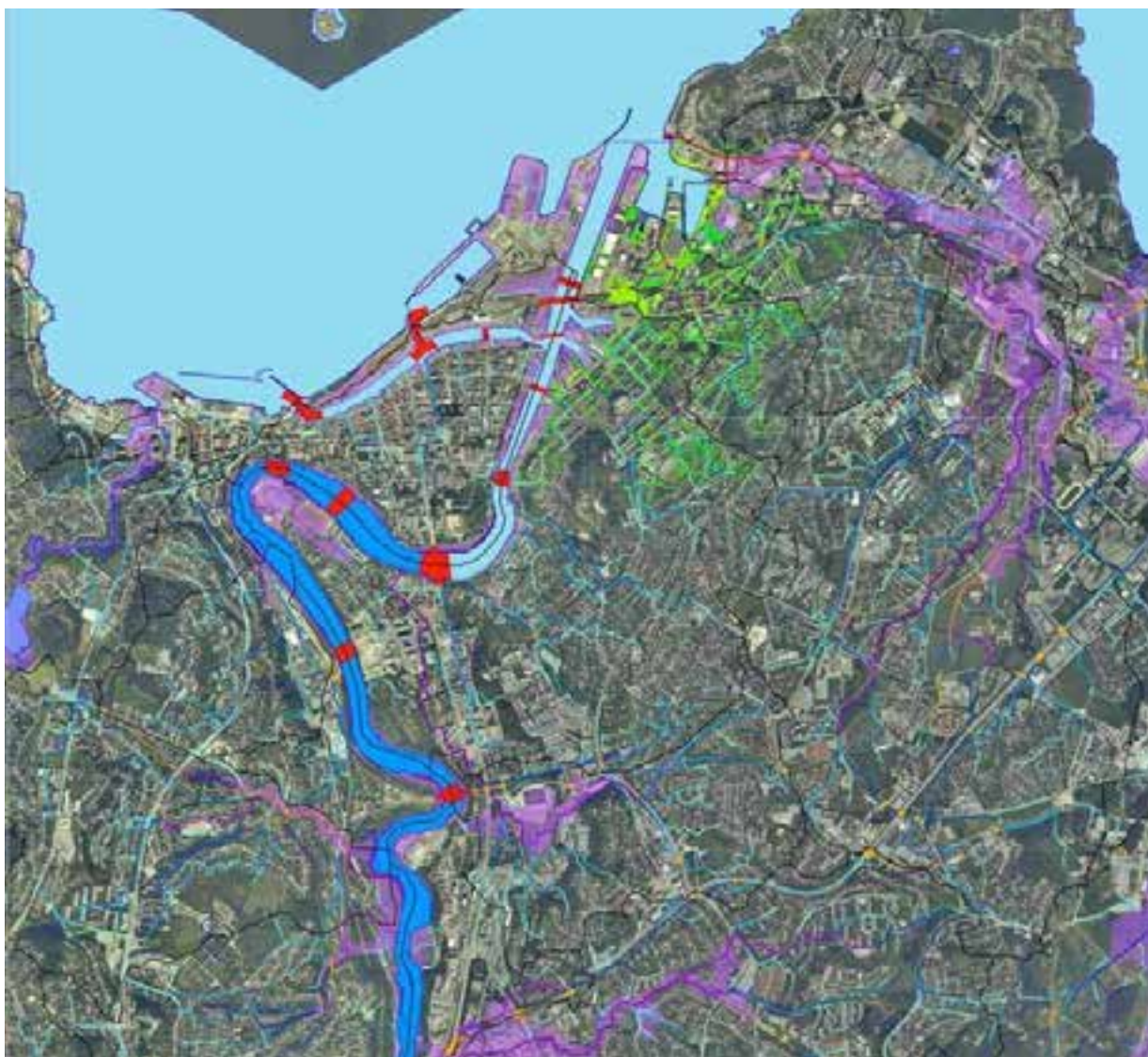
Figur 19. Sammenstilling av resultater fra ulike metoder for flomveger i Trondheim kommune (GIS metode- dreneringslinjer (blå), kombinert ledningsnett og overflatestrømning (grønn) og NVE sitt aktsomhetskart for flom (rosa)(Johannessen, 2013)
