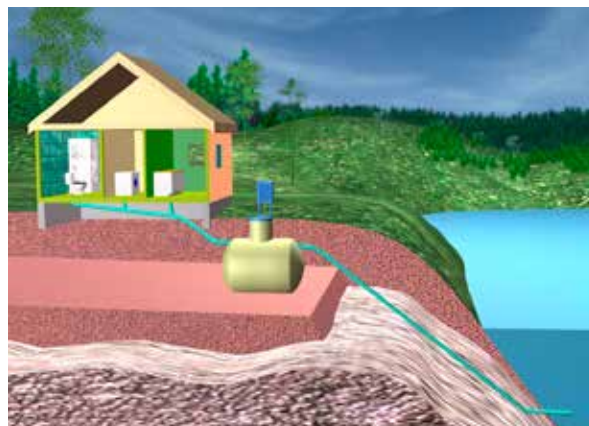
Figur 14.5 Prinsipp tegning av et minirensanlegg (Hensel og Yri 2007).
