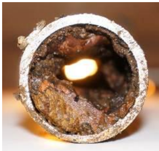
Figur 61. Til v.: Det registreres ofte vannlekkasjer i forbindelse med gamle anboringsklammer. Til h.: Begroing i 40 år gammelt galvanisert stålrør (Foto: Asplan Viak as/ Devegg Ruud).
