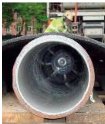
Figur 58. Demo av PU-Liner, og ferdig belagt vannledning (Foto: Asplan Viak as/ NCC as).
