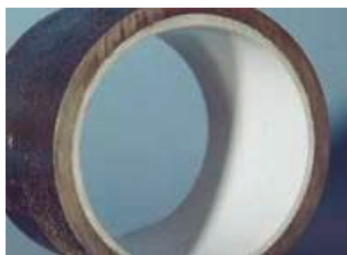
Figur 58. Demo av PU-Liner, og ferdig belagt vannledning (Foto: Asplan Viak as/ NCC as).
