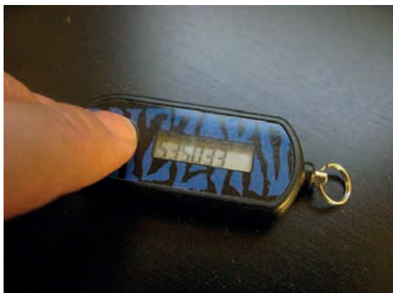
Figur 14: Eksempel på kodegeneratorenhet 6 brukt i tofaktor autentiseringssystem.
