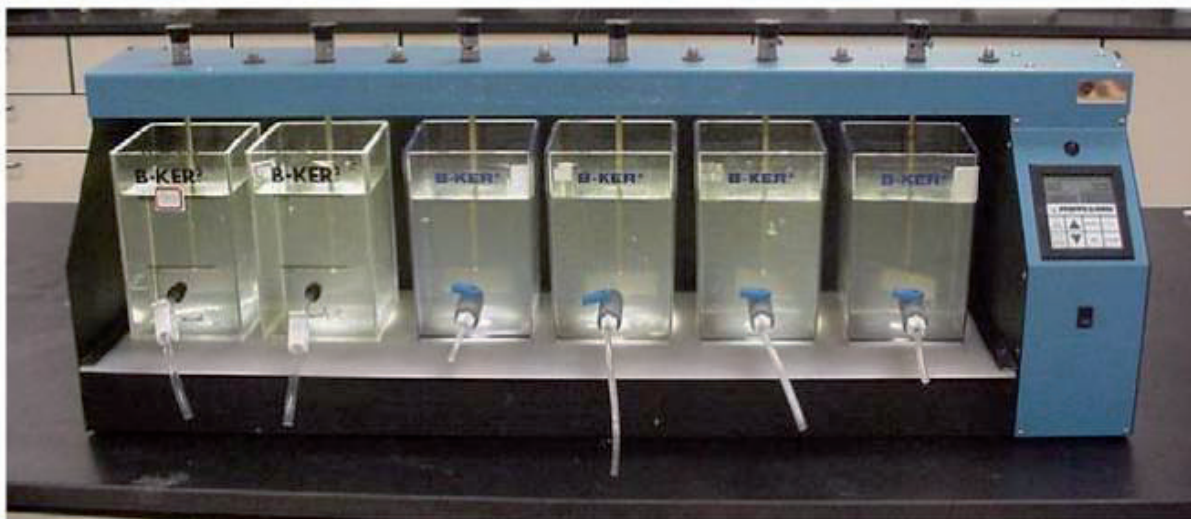
Figur 3-1. Jartester med 6 forsøksbegere med testvann og med ulike pH og koagulantdoser, omrørere med varierbar hastighet, samt prøvekraner for uttak av vannprøver
