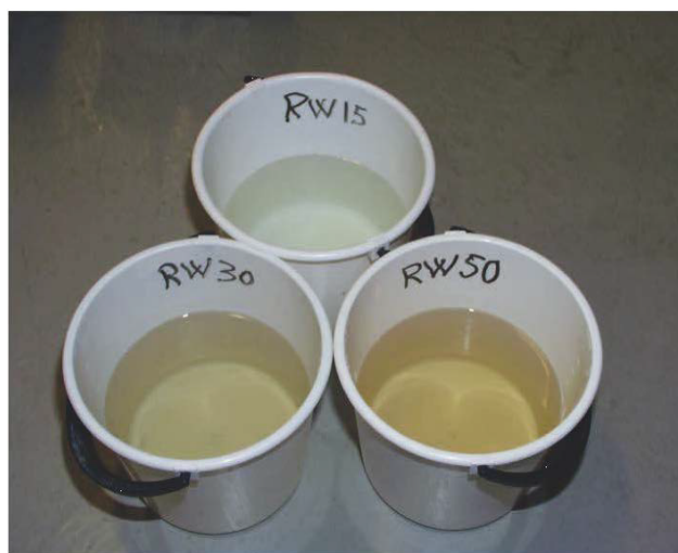
Figur 6-7 Naturlig organisk materiale (NOM) i vann: Fargetall på 15, 30 og 50 mg Pt/L (Foto: B. Eikebrokk, 1985)
