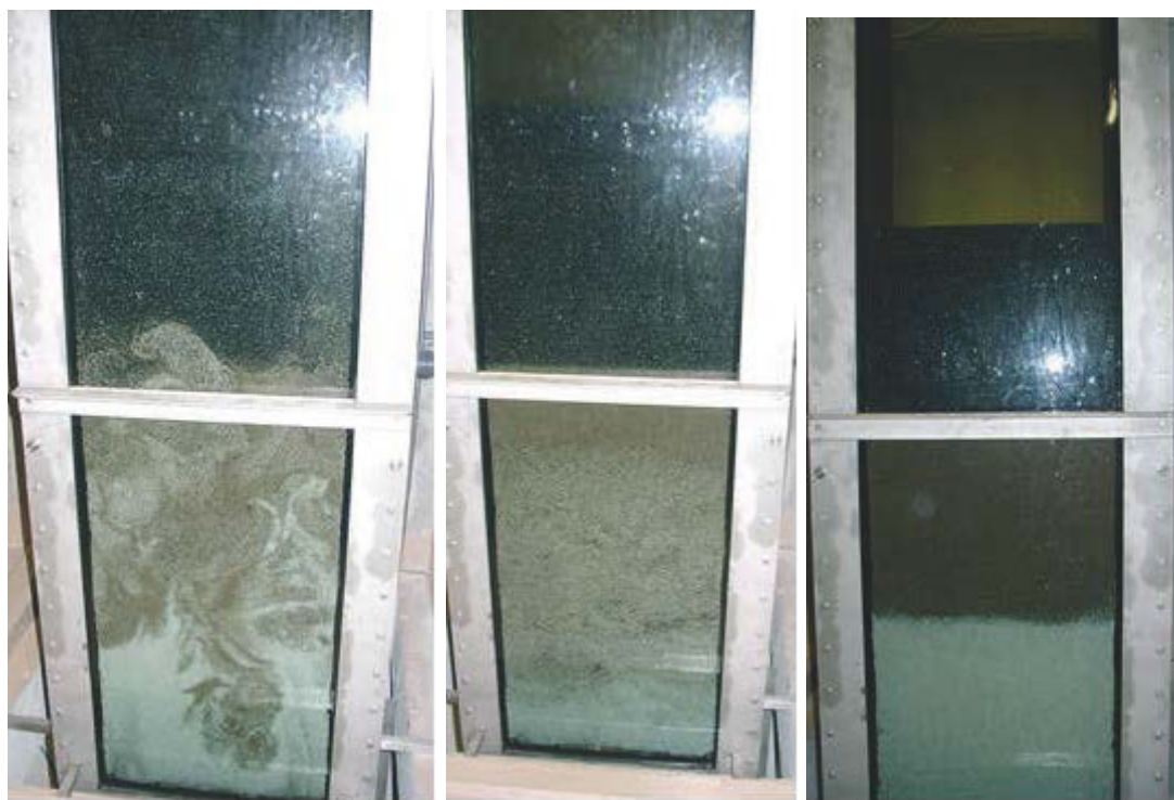
Figur 8-5 Tilbakespyling av et tremediafilter. Til venstre; omblending under spyling, i midten: dårlig lagdeling pga for lav spylehastighet, til høyre: god lagdeling; antrasitt øverst, kvartssand i midten og marmor nederst (Foto: J. Brandt).
