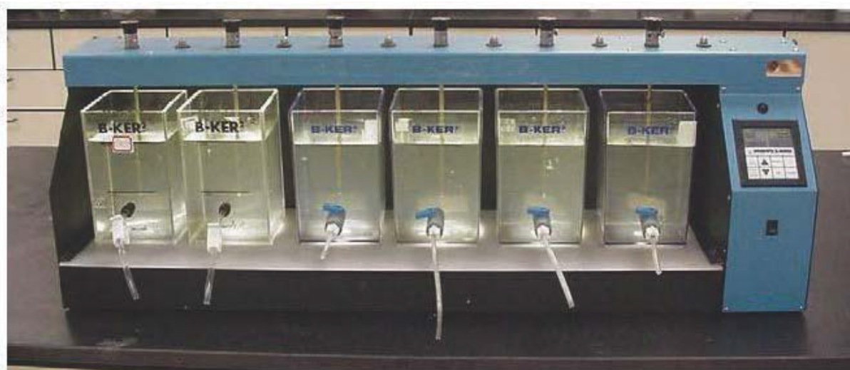
Figur 6-3 Jartester med 6 forsøksbegere med testvann og med ulike pH og koagulantdoser, omrørere med varierbar hastighet, samt prøvekraner for uttak av vannprøver
