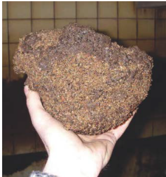
Figur 8-7 Slamklump (mudball) fra et filter (Foto: J. Røstum)
