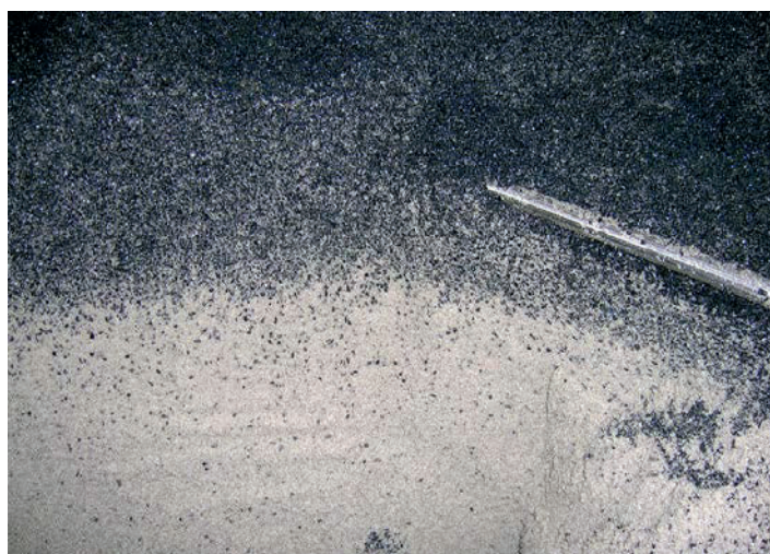
Figur 8-4 Snitt gjennom en filterseng med en blandsone mellom antrasitt og kvartssand (Foto: F. Ordning)
