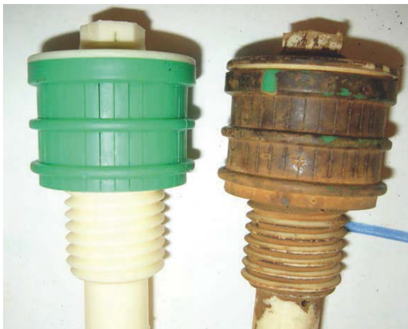
Figur 7-4 Nye og gamle dyser (med utfelt jern) fra Gopledal vannverk (E. Mathiesen)
