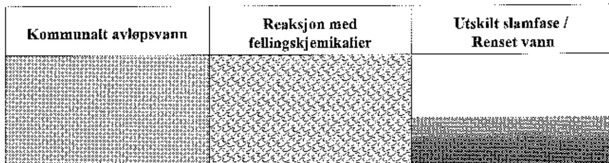
Figur 6: Illustrasjon av kjemisk fellingsprosess.
